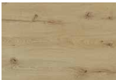
L1 HRAST GRČA PUKOTINA
