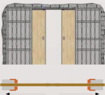
DVOKRILNA VRATA U ZIDU
